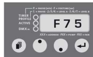
Abb. 18: Einstellen des Lüfters (Fan)-Wertes
