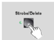
3. Drücken sie nun Strobe/Delete um das unerwünschte Gerät zu löschen. Alle LEDs auf dem Controller blitzen wiederholt auf um das Löschen zu bestätigen.
