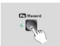
2. Dann drücken sie FN/RECORD um das LED Gerät zu initialisieren. Alle LED Anzeigen auf dem Controller blinken 3 mal auf zur Bestätigung.
