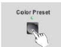
4. Drücken sie nun den Color Preset Knopf unter dem sie die Farbe speichern wollen. Alle LED Anzeigen des Controller blinken 3 mal zur Bestätigung.
